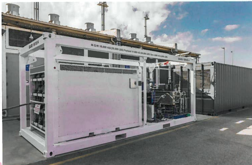
In 2016 heeft het Duitse bedrijf Sunfire 's werelds grootste reversibele elektrolysemodule geleverd aan de Amerikaanse Boeing voor een energysysteem dat de Amerikaanse marine uittest. Het gaat om een zogenoemde reversible solid oxide fuel cell (RSOC) die waterstof kan omzetten in elektriciteit en omgekeerd een overschot aan elektriciteit kan omzetten in waterstof. Omschakelen kan binnen een paar minuten
