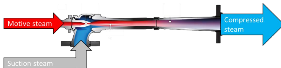
Figuur 2: Werking stooimejector
